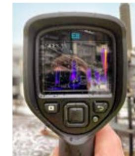
Beispiel für eine Infrarotuntersuchung von Freiluftendverschlüssen, die keine Auffälligkeiten zeigt.
