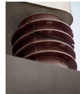
Beispiel für einen defekten Isolator unterhalb der Adaptergrundplatte des Freiluftendverschlusses, der im Rahmen der visuellen Inspektion entdeckt wurde.
