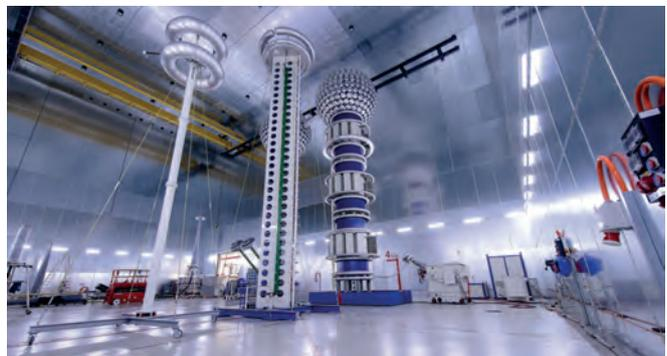
Bild 4: Stossspannungsgenerator zur Prüfung des Stossspannungsverhaltens der Kabel.
