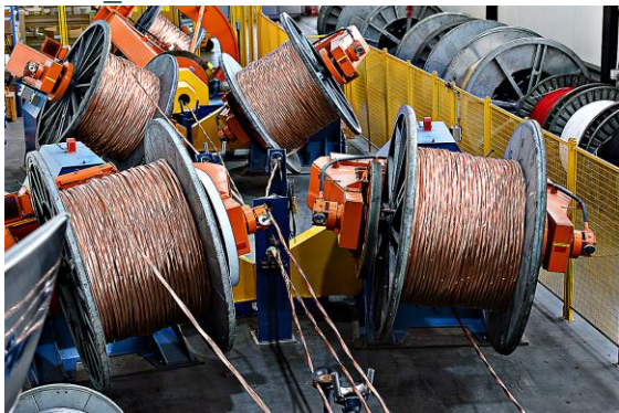
Bildlegende: Universalverseilmaschine Kabelproduktion Standort Brugg
